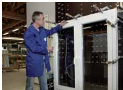
RAL-Fensterprüfung auf Funktions-, Sturm- und Starkregendichtigkeit
