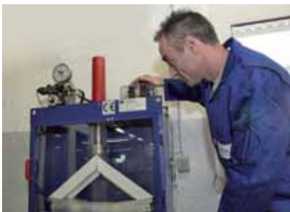
RAL-Prüfung der vorgeschriebenen Festigkeit der Eckenverschweißung
