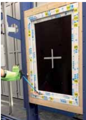
Einbruchschutz-Prüfung: Climatic-Fenster verfügen serienmäßig über Sicherheitstechnik RC 1 N, geprüft und zertifiziert.
