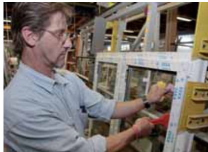
Climatic Fenster werden zum Verklotzen der Glasscheibe in die Glaspresse eingespannt. Gut für Funktion und Montage.
