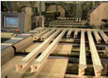
Vollautomatische Stabbearbeitungs- und Montageanlage für exakte Profilbearbeitung.
